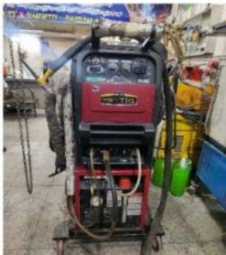
شکل 2- دستگاه مورد استفاده در جوشکاری TIG.
